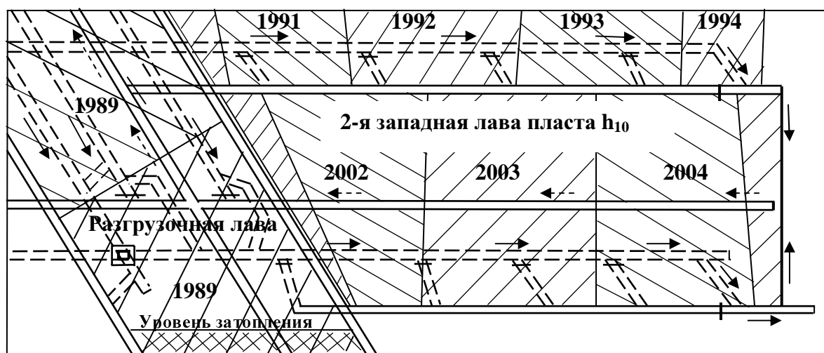
Рис. 1 – Схема горных выработок 2-й западной лавы пласта h_{10} шахты им. М.И. Калинина
